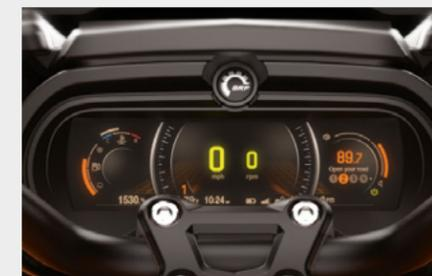
**DIGITALANZEIGE:** Großes 7,8" LCD-Panoramafarbdisplay mit BRP Connect™ zur Integration fahrzeuoptimierter Smartphone-Apps wie Mediaplayer oder Navigationssystem mit Bedienung über die Lenkergriffe.
