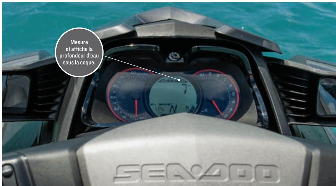
Mesure et affiche la profondeur d'eau sous la coque.
