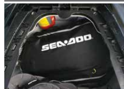
COMPARTIMENT DE RANGEMENT AVANT AVEC BAC AMOVIBLE ET ETANCHE
